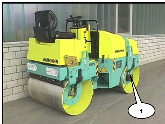
Motor de propulsión frontal (1)
