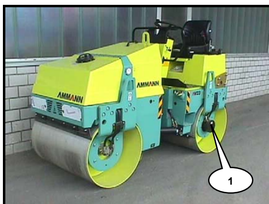
Motor de propulsión trasero (1)
